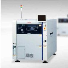
**솔더 페이스트 인쇄 기계** : 솔더 페이스트(크림)은 구성 요소를 보드에 부착하는 데 사용된다. 기계 안 솔더 팬 위치에 회로 기판을 고정해서 표면에 정확한 양을 적용할 수 있게 기계를 설정하고 고르게 도포한다.
