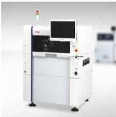
**AOI 기계** : 자동 광학 검사(AOI)는 픽 & 플레이스 구성 요소의 품질을 평가하여 결함 여부를 파악하기 위해 수행된다. 고출력 카메라를 이용해 모델 설계와 비교한다. 용접 연결에 따라 빛이 반사하는 다양한 방식을 보고 품질이 낮은 솔더를 식별한다. 그러나 복잡하거나 다층 PCB의 경우는 잠재적인 문제를 확인하기 위해 X선으로도 촬영한다.
